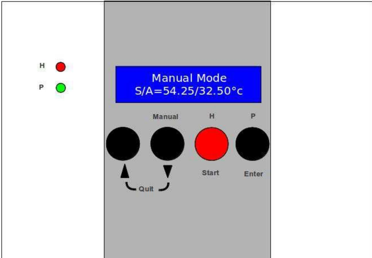
Come suggerisce il titolo, la MODALITA' MANUALE consente di controllare manualmente la temperatura, il riscaldamento e la pompa.
